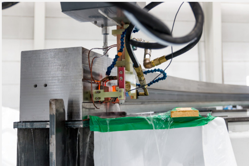
Bild 7: Härtung eines Segments in der Erprobungsphase (Quelle: SMS Elotherm)
