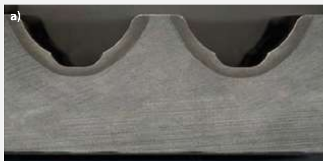
Bild 4: a) Schnitt eines doppelreihigen Kugellagerings mit induktiv gehärteten Laufbahnen; b) Simulation der Induktionshärtung mit einem Induktor (Quelle: SMS Elotherm GmbH)
