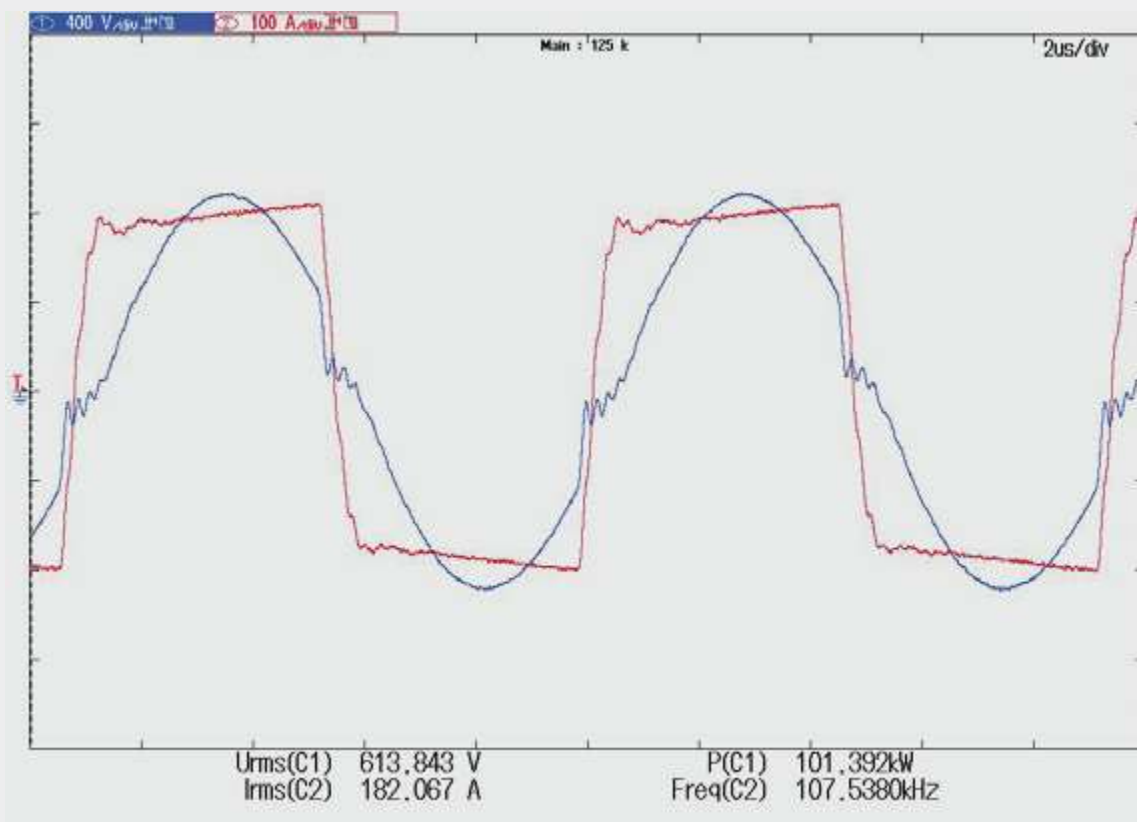
Bild 7: Zeitliche Verläufe der Ausgangsspannung (blau) und des Ausgangsstromes (rot)
