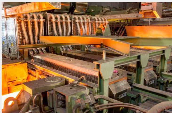
Bild 4: Integration einer Induktionserwärmung in eine CSP-Anlage
