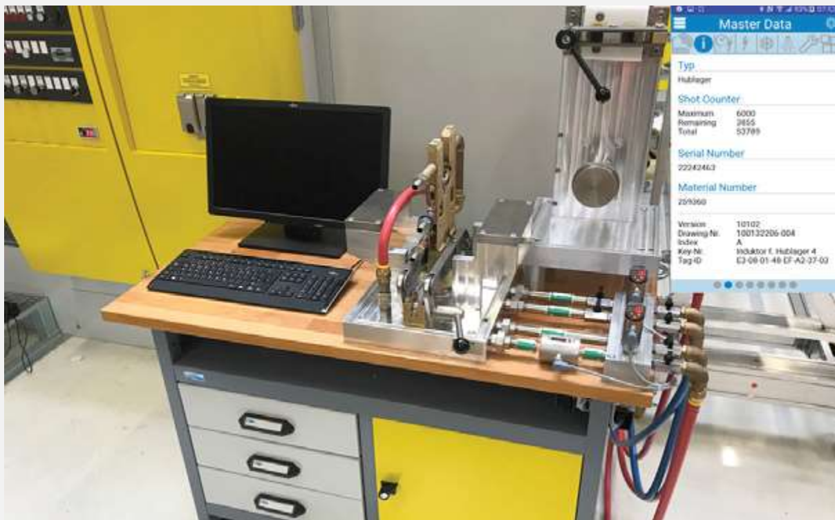
Bild 10: Induktorprüftisch mit Durchflussmengenprüfung und Rechneranbindung, o.r.: Auszug der Handy-App
